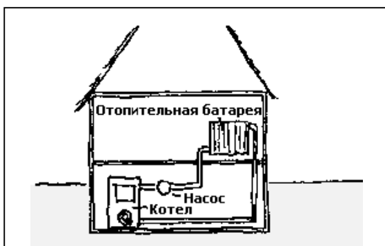
Рис. 1.1. Энергоноситель “горячая вода” доставляет энергию от отопительного котла к батареям центрального отопления.
