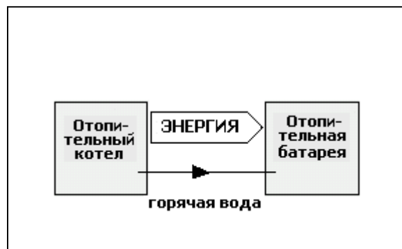
Рис. 1.4. Схема потока энергии для Рис. 1.1.
