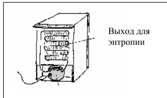
Рис. 10.8. Холодильник сзади. Видны тепловой насос и змеевик, через который энтропия покидает холодильник
