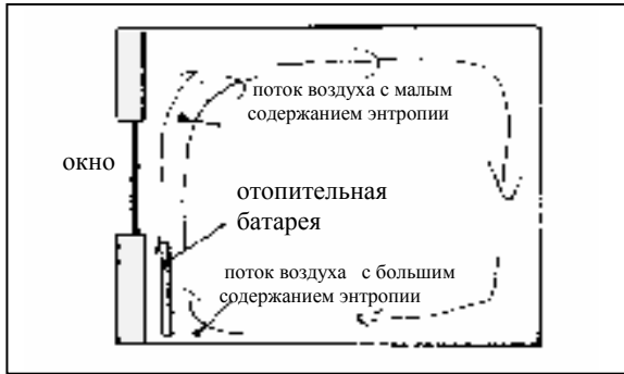
Рис.10.27. В помещении энтропия перераспределяется с помощью конвекции
