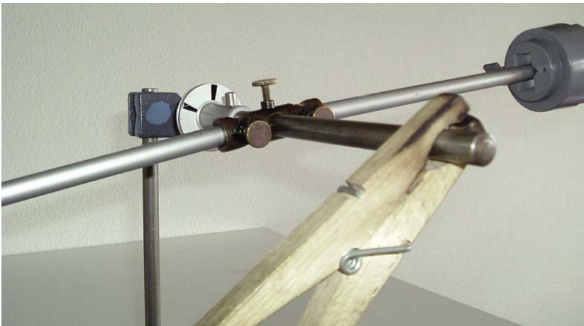
Abb. 2. Durch die Gleitreibung zwischen Klammer und Achse wird ein Drehimpulsstrom realisiert, der unabhängig von der Winkelgeschwindigkeit ist.
