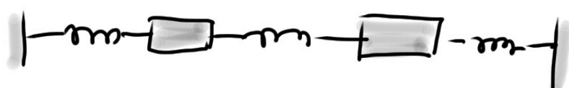
Abb. 2. Federschwinger mit zwei Freiheitsgraden
